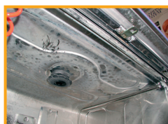
Spülkammer mit starkem Kalkbefall
