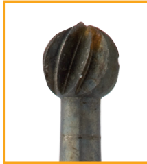
Korrodiertes Bohrer aus Werkzeugstahl. Ursache: Material ist für die maschinelle Reinigung ohne Korrosionsschutzschicht nicht geeignet.
