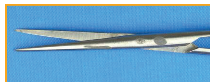
Links: Partieller Materialangriff durch sauren Zemententferner und rechts durch Tinktur zur Blutstillung. Ursache: zu lange Kontaktzeit oder unzureichende Entfernung nach Anwendung.
