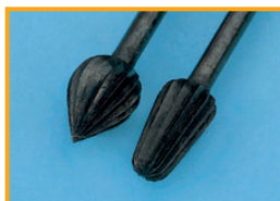
Rost an Bohrem Ursache: Aufbereitung eines Einmalinstrumentes
