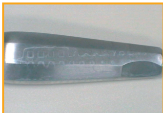
Verschleppung von Reinigungsmittelrückständen durch unzureichende Spülung
