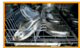
Falsche Beladung eines Reinigungs- und Desinfektionsgerätes
