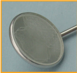
Verfleckungen auf Grund hohen Salzgehalts im Abspülwasser
