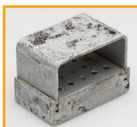
Starker Materialangriff natur- und farbeloxierter Aluminiumoberflächen bei einem Instrumentenständer und Containern. Ursache: Überdosierung der sonst materialverträglichen alkalischen Waschlösung.
