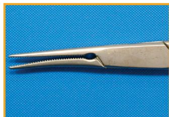
Verformung durch unsachgemäße Handhabung
