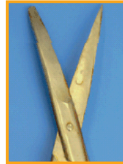
Korrodierte Schere aus nicht rostendem Stahl. Ursache: Folgeschaden aufgrund eines Säureangriffs, ausgelöst durch Überdosierung des Grundreinigers.
