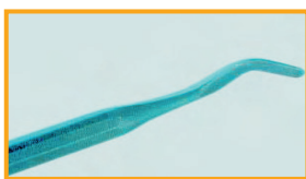
Korrodierter Füllspatel Ursache: Anbeizung durch sauren Zemententferner
