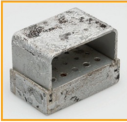
Stark angegriffener eloxierter Aluminiumständer
