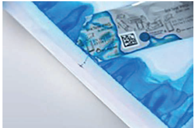
Abb. 6: Test nicht bestanden (Kanalbildung)
