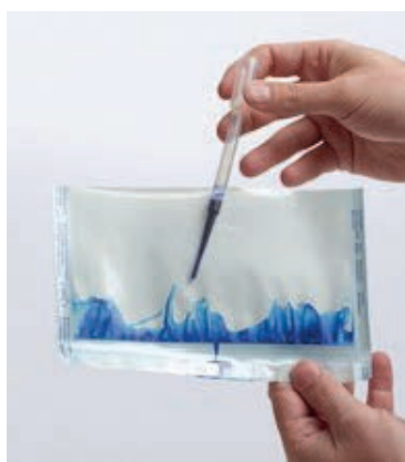
Abb. 8: Test nicht bestanden (Kanalbildung)
